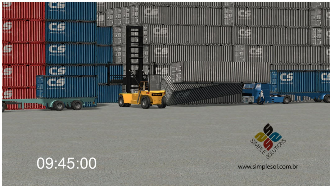
Figura 5 – Empilhadeira recuando derruba dois contêineres
